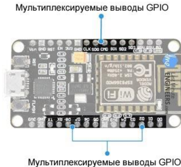
Рис. 36 – Мультиплексируемые выводы GPIO платы ESP8266 NodeMCU
